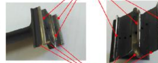
Наплавка входной кромки и торца
