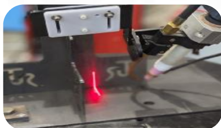
ПОИСК ДЕФЕКТОВ В ГЕОМЕТРИИ СВАРНОГО ШВА
